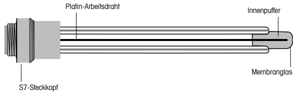
Bild 9. pH-Elektrode mit pH-sensitiver Membran.
